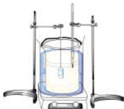
Figura 2. Montaje del baño de recubrimiento.
