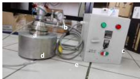
Figura 1. Sistema de reacción usado en la hidrogenación de palmitato de metilo, a) reactor batch, b) válvulas de presión de ingreso de H 2 , c) controlador de temperatura, d) chaqueta de calentamiento, e) conexiones eléctricas.
