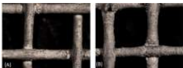
Figura 3. Micrografías de la malla M2 recubierta con las suspensiones TPa (a) y TPc (b).
