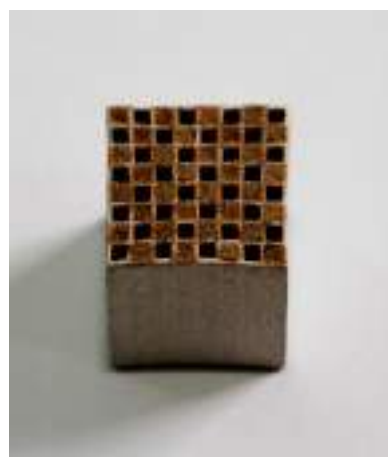
Figura 2. Estructura monolítica “wall-flow” para el filtrado y combustión de partículas de hollín.
