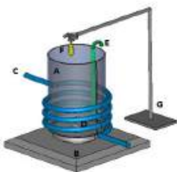
Figura 1. Reator batelada de bancada para as reações de fotocatalise: A) Reator batelada; B) Agitação magnética; C) sistema de resfriamento; D) agitação magnética; E) Oxigenação da reação; F) Radiação UV e G) Suporte para a lâmpada.
