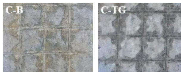
Figura 2. Test de rayado en soporte aluminato de calcio sin (C-B) y con recubrimiento de TiO 2 -2%GO (C-TG).
