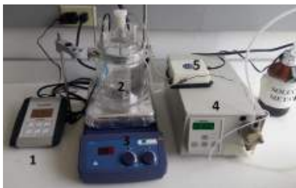
Figura 1. 1. pH metro SI ANALYTICS LAB 845, 2. Reactor Semibatch, 3. Plancha de calentamiento LB pro MS7-H550-S, 4. Bomba peristáltica, 5. Bomba de aire. Test catalítico oxidación amoxicilina.
