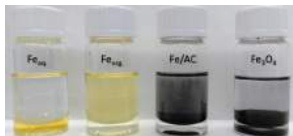
Figura 2. Imagen de la distribución de los catalizadores objeto de estudio en el sistema bifásico ciclohexano-agua.
