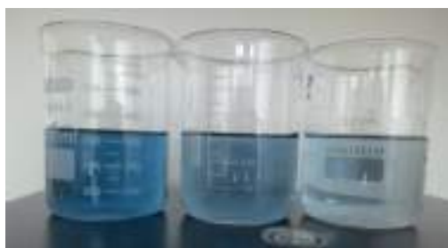
Figura 7. a) Corante sem tratamento, b) tratado por fotocatalise com ZnO puro, c) tratado por fotocatalise com 5% ZnO/NaA.
