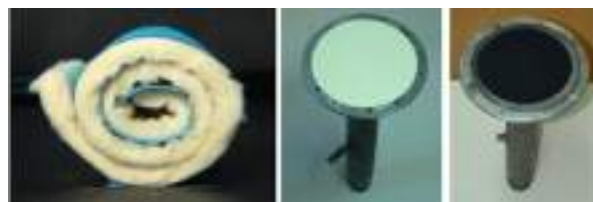
Figura 1.b. Papel cerámico y filtro antes después de ser utilizado en banco de pruebas (motor diésel).
